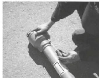
Рис. 8 Демонтаж защитного кожуха.
