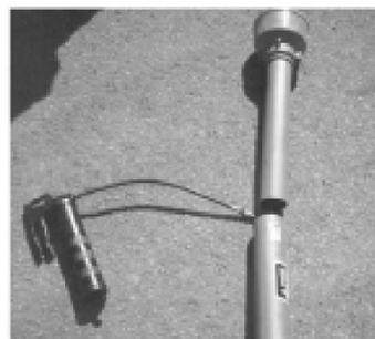
Рис. 10 Смазка телескопической секции.
