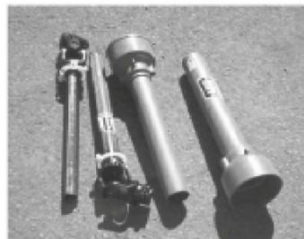
Рис. 9 Вал в разобранном виде.
