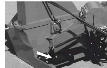
Положение стационарного ножа
