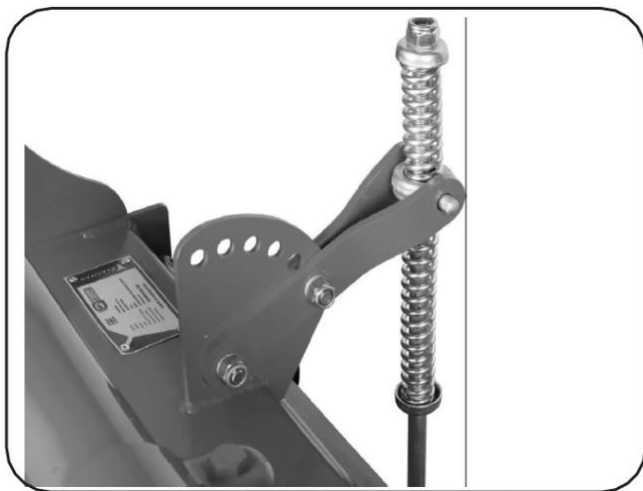
Рис. 24 Положение подпружиненного узла и штанги при стоянке
